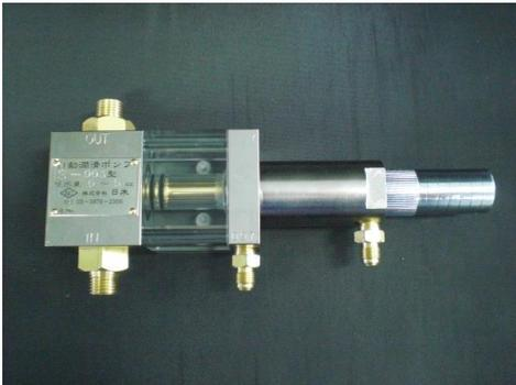
S-003型潤滑ポンプは、プランジャーチップへの潤滑剤供給をより正確、確実にこなうことができるように開発された潤滑ポンプです。当社製S型潤滑ポンプに対し、潤滑剤の充填室をアクリル素材にする事でプランジャーピストンの動作を外部から目視確認ができるようになりました。これにより潤滑剤の吸入状態やピストンの動作を目視にて管理する事が可能となりポンプへの吸入不良等を確認する事が出来ます。なお、ポンプの取り付け穴位置は従来のS型ポンプとは異なっておりますので、取り付けの際には寸法をご確認ください。
