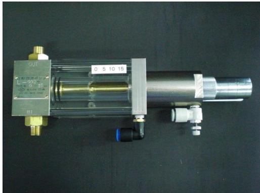
L-002型潤滑ポンプは、プランジャーチップへの潤滑剤供給をより正確、確実におこなうことができるよう開発された潤滑ポンプです。当社製L型潤滑ポンプに対し、プランジャーピストンの動作と高圧側ピストンOリングの交換時期を外部から目視確認ができるように変更し、スケルトンボディにすることでポンプ内の潤滑剤充填量も確認する事が出来るようになりました。
