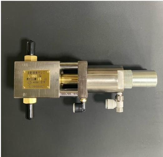
L-001型潤滑ポンプは、プランジャーチップへの潤滑剤供給をより正確、確実にこなうことができるように開発された潤滑ポンプです。従来の当社製L型潤滑ポンプに対し、プランジャーピストンの動作と高圧側ピストンOリングの交換時期を外部から目視確認ができるように変更しました。これにより潤滑剤の吐出・ピストン速度のより細かな管理が可能となりました。
