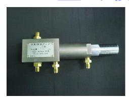
1 S型潤滑ポンプは、プランジャーチップへの潤滑 剤供給をより正確、確実におこなうことができるよ うに開発された小、中型マシン用自動潤滑ポンプで す。1 S型潤滑ポンプは、2 S型と同様、ピストン ストロークを変えずにシリンダー内径を小さくし、 1 cc の範囲内で吐出量の微調整が可能となりました。 なお、ポンプの外形寸法、取り付け穴位置、および 潤滑剤の吸入・吐出口の口径等が従来の S型、2 S型 と異なりますので、御了承下さい。
